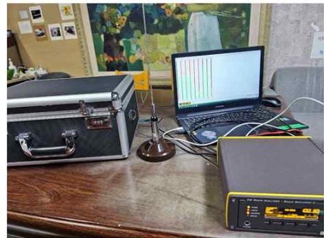
그림 17. 실내실험2 전계강도 측정기 구성도 및 측정 모습 사진
